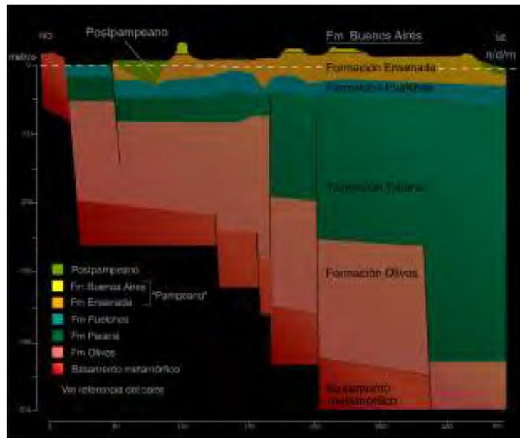
Figura 4: Esquema de corte estratigráfico suelo – subsuelo
